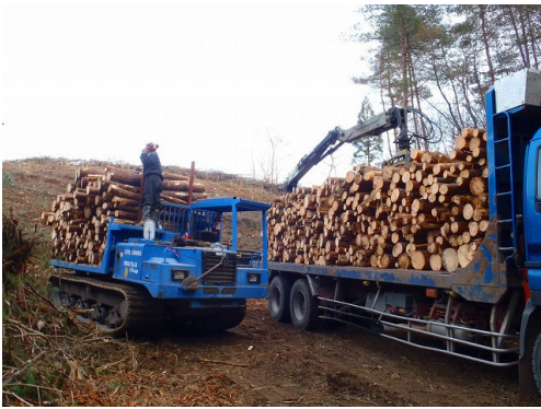
集材した材をトラックに積込
