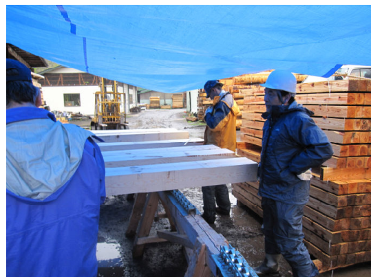
写真2 平角材測定の様子（乾燥期間にもよるが、4mの平角材1本あたりの重量は70～150kg）
