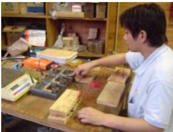
写真1 含水率計の補正用試験
