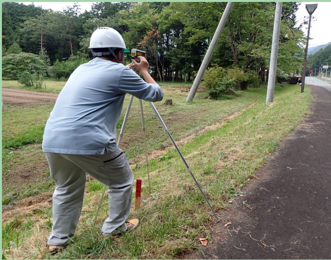
コンパス測量の基礎
