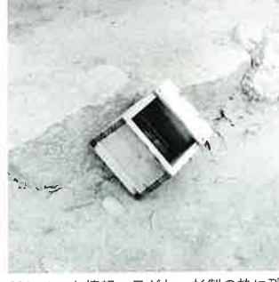
691 ノート情報：目がね 杉製の枠に硝子はめる 大工に頼んで作ってもらう。野田にこれを作るのを得意とする大工住む。一この部分を手で押えて硝子をのぞく
