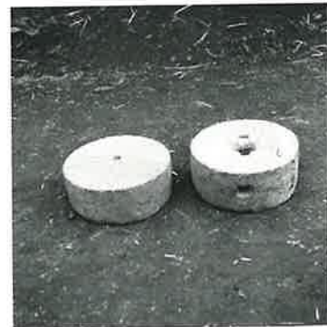
612 ノート情報:ヤギリ(ひきうす)豆腐をひくときに用ゆ。刻んだ筋を「目」という(「目切りする」という)。
