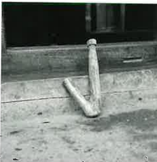
848 ノート情報：マオケをかけるカギ木 鉋と鋸を使って自家製 37cm 20cm
