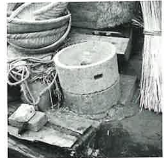
611 ノート情報:ヒキウス 米、ソバ、ムギ、豆をひく。石 市販。直径1尺(内ふちの厚さ8分) 全長8寸。
