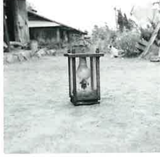
690 ノート情報：ガス燈 イカツリ用 硝子面はタテ7寸8分 横寸4寸2分
