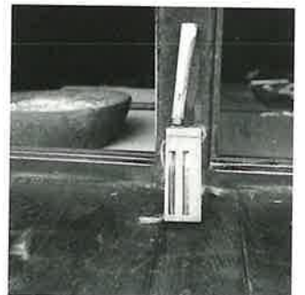
626 ノート情報:ナダのサヤ ツキノ木 自製 全長7寸 巾2寸5分 厚さ7分
