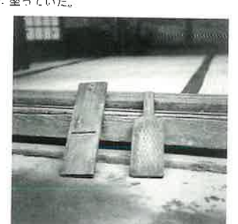
793 ノート情報：大根おろし 歯は竹 台木製 ナマスすり 台は木、おろす口に金具の歯をつけた。口の表面は斜めにへこんでいる。大根を線にするとき用いる。長さ30.4cm 幅8.5cm
