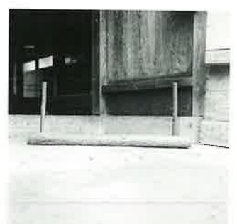
842 ノート情報：縄たぐり 縄の長さ(何ヒロあるかを)計るのに用ゆ 1ヒロは5尺 スサの木を用ゆ スサの木は滑らかなので縄のすべりよし
