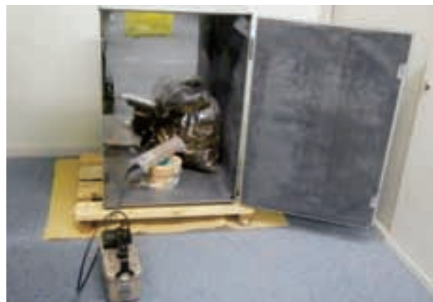
遮蔽した状況での線量率測定
