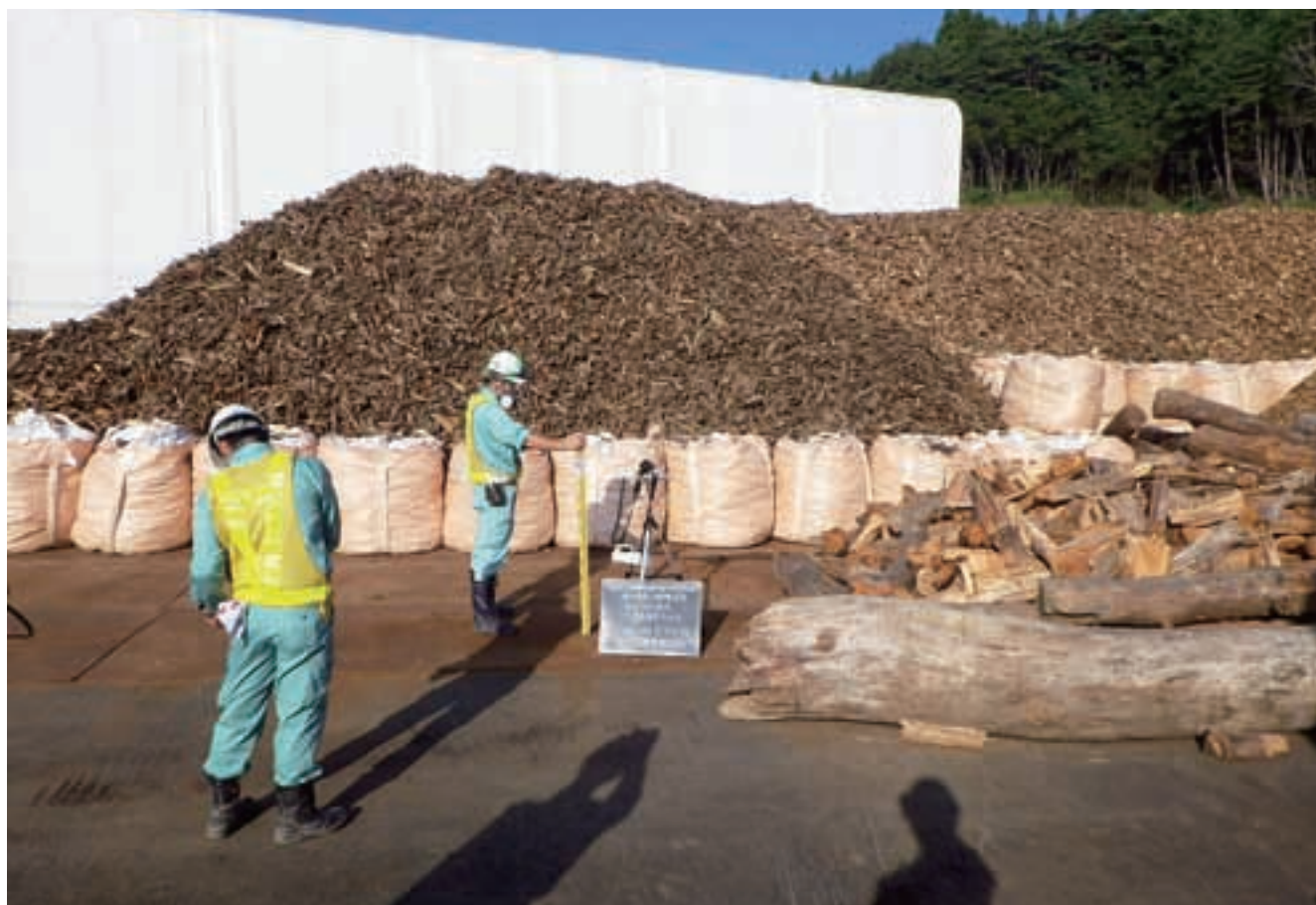
災害廃棄物仮置場での空間線量率測定
