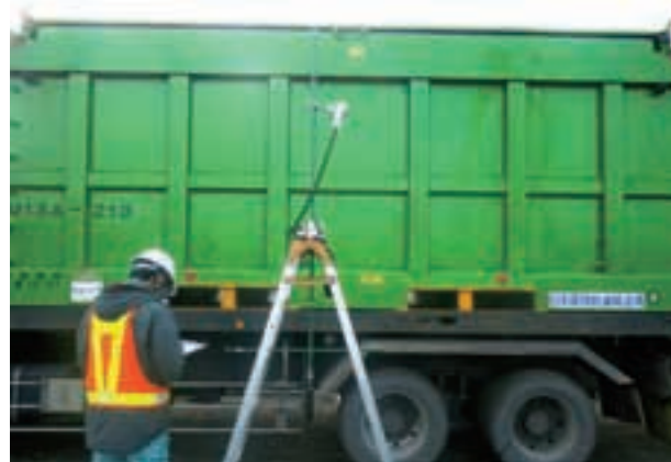
災害廃棄物を搬送するコンテナの空間線量率測定
