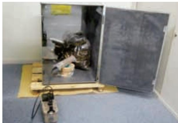
遮蔽した状況での線量率測定
