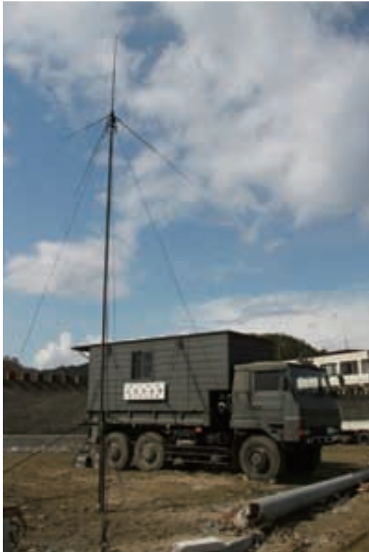
田野畑地区に設置された自衛隊の無線中継基地
